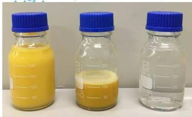
左-原液 (糖度11.7%) 中-母液(濃縮) (糖度36.0%) 右-回収液 (糖度0.0%)
